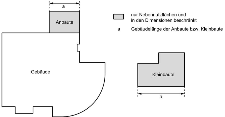
Figur 2.1 - 2.3 Gebäude, Kleinbauten und Anbauten
